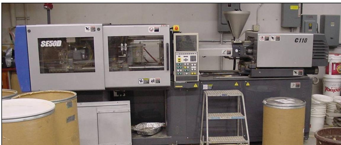
Machine à moulage par injection
