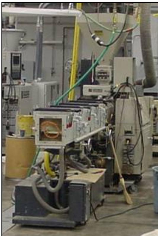
Extrudeuse double vis coniques 35 mm contre-rotatives avec chambre de refroidissement à jets d'eau
